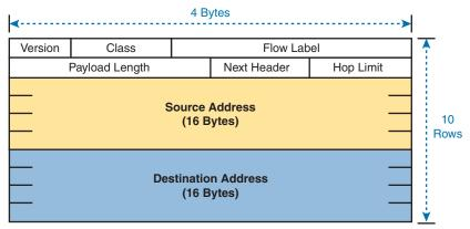
Figure 25-3 IPv6 Header
